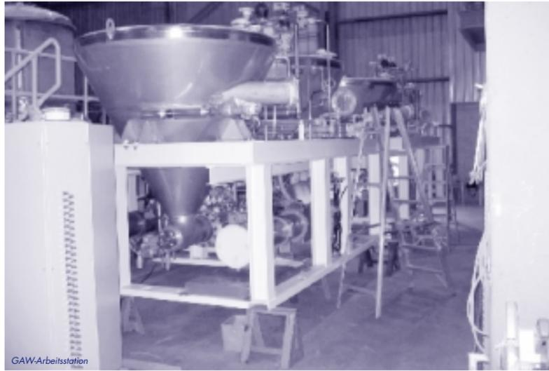
Im Rahmen des Umbaus der PM12 bei Sappi Cloquet im US-amerikanischen Bundesstaat Minnesota wurde GAW mit der Entwicklung einer modularen Arbeitsstation zum Voith Speed Sizer beauftragt. Aufgrund sehr enger Zeitvorgaben musste die Anlage innerhalb kürzester Zeit geplant und gefertigt werden. Der Einbau und die Inbetriebnahme erfolgten während einer Stillstandsdauer der Papiermaschine von nur 10 Tagen!
